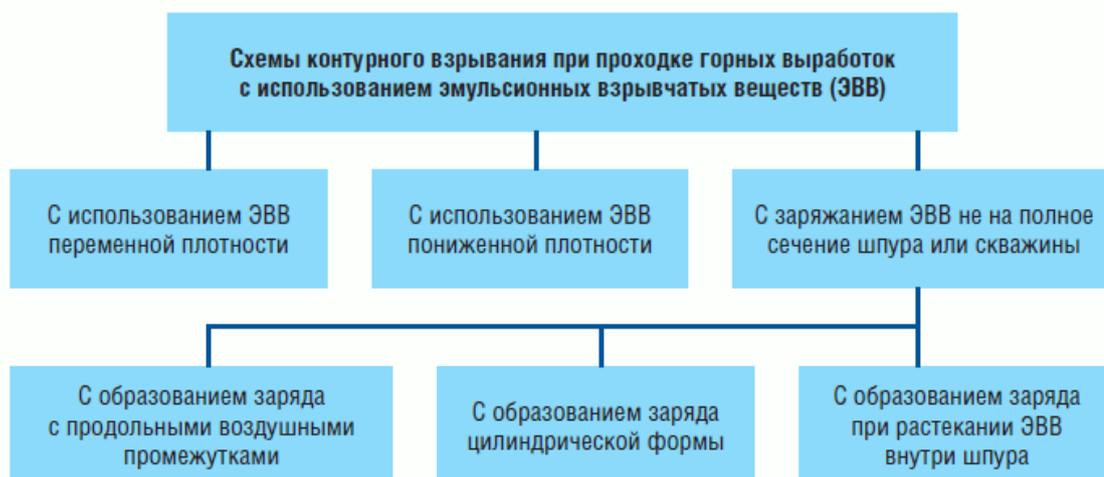
Рисунок 2 – Схемы контурного взрывания при использовании эмульсионных взрывчатых веществ
