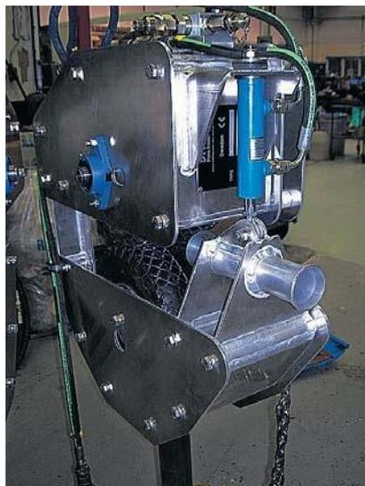
Рисунок 7 – Отводчик шланга, испытанный на подземных рудниках АО «Апатит»
